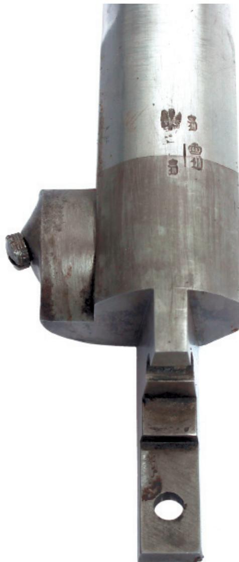
Prüf- und Abnahmestempel auf der Laufunterseite
