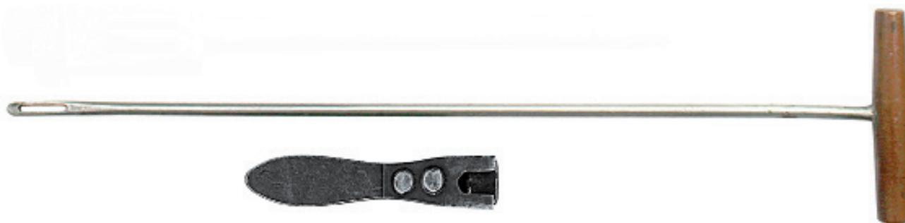
Reinigungsstock und Ladelöffel mit gabelförmigem Federblatt zum Einsetzen der Zielpatrone M 20
