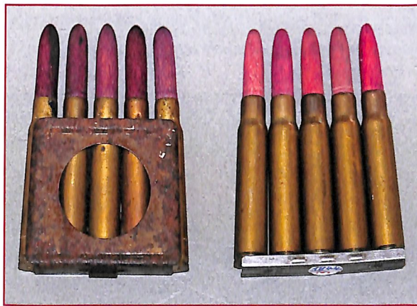
Links Laderahmen 88 mit Platzpatronen 88. Rechts Platzpatrone 33 mit Laderahmen für das Mod. 98.
