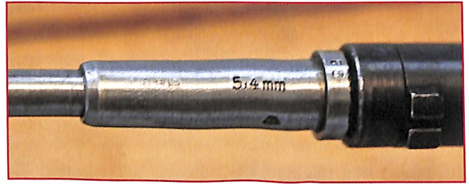
Im Bereich des Patronenlagers, des E.L.24 Einzellader befindet sich der zivile Beschuss, die Waffennummer, das Laufkaliber und der militärische Abnahmestempel.
