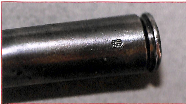
Der untere Teil des Zielläufchens 98. Deutlich ist der militärische Abnahmestempel zu erkennen. Diese Art der militärischen Abnahmestempel wurde zu Beginn der 1920er Jahre noch verwendet.
