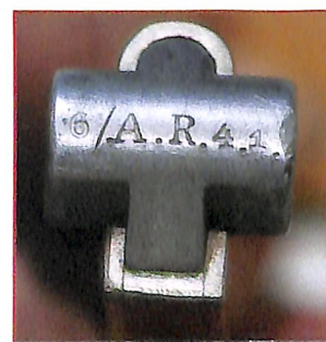
Kniegelenk des Einstecksystem 08 mit ausgeschriebenem Hersteller auf dem Verschlusskopf sowie den militärischen Abnahmestempeln auf den Verschlussteilen.
