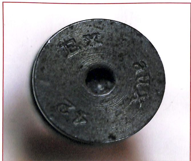
Patronenboden der Exerzierpatrone 08 mit Stahlboden und Plastikkorpus.
