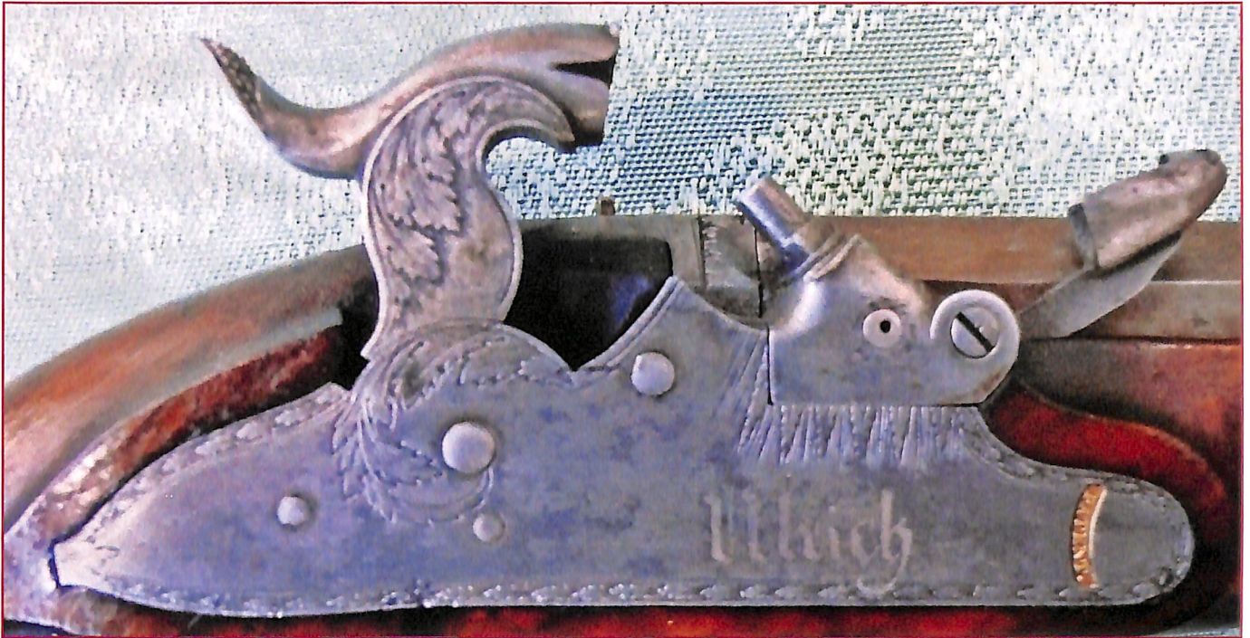
Schloss mit halbverdecktem Hahn und Pistonsicherung um 1830 (auf der rechten Seite der Schlossplatte Hinweis in Gold auf Ulrichs Patente von 1827 und 1828)
