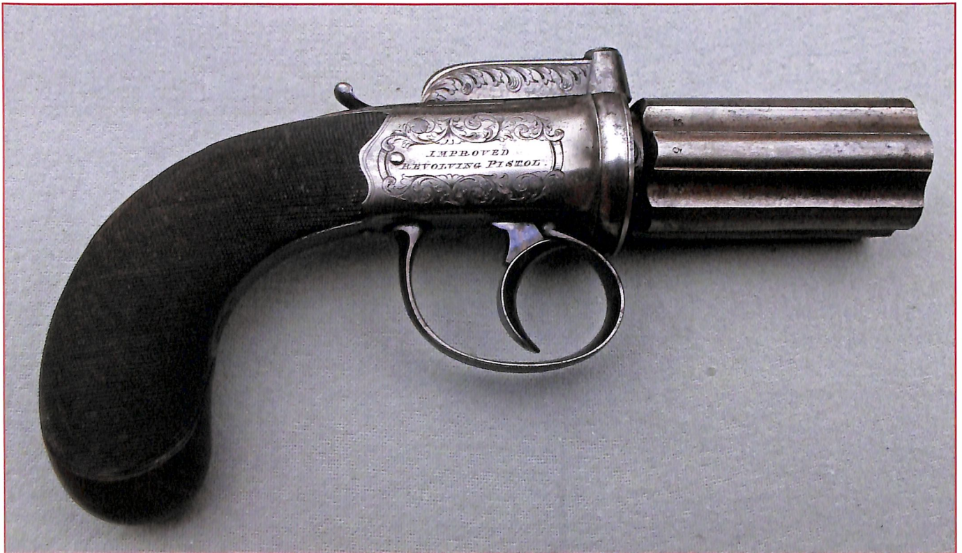
Bündelrevolver 105 bore Lauflänge 3 Zoll Laufbündel und Schlossgehäuse sowie übrige Teile bunt gehärtet Beschriftung links: C. & H. Egg London rechts: Improved Revolving Pistol Birmingham Beschuss Griff: Nussbaum Vollholz Schloss: Tranter Modifikation
