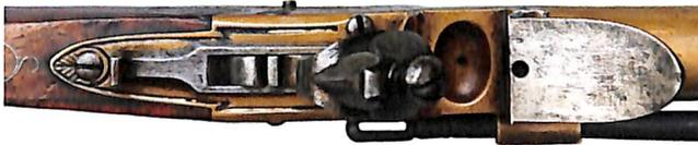
Sicherungsschieber hinter dem Steinschlosshahn
