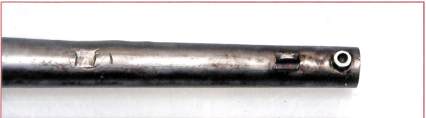
*eine Laufhalteöse entfernt, die Gewindebuchse nachgerüstet*
