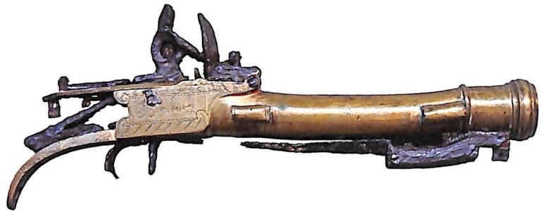
*Bei diesem Wasserfund hat sich das Schaftholz bereits vollständig aufgelöst, und auch die eisernen mechanischen Funktionsteile sind bis zur völligen Unbrauchbarkeit korrodiert. Die Buntmetallkomponenten dagegen haben die schädlichen langjährigen Einflüsse des Salzwassers fast unbeschadet überstanden.*
