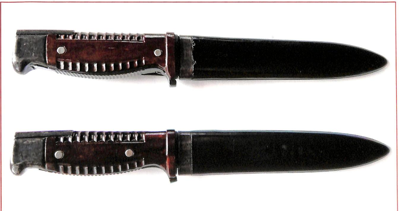
*Seitengewehre 42 (erste und zweite Variante) in den zugehörigen Scheiden versorgt. Deutlich kann man an der Stellung der Griffnieten die beiden Varianten unterscheiden. Oben die zweite Variante mit weiter vorne liegender Niete als bei der ersten Variante (unten)*
