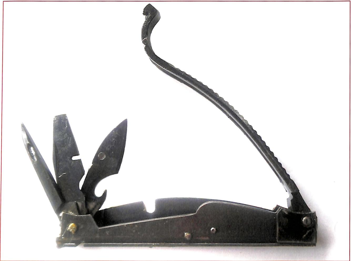
*Der Werkzeugeinsatz wie er ab der zweiten Variante regulär Verwendung fand. Er besteht aus Ahle, Schraubendreher mit Kabelabisolierer, Messerklinge mit Kapselheber, Korkenzieher sowie Hülsenauszieher und Hufräumer welche durch den Deckelbügel gebildet werden.*
