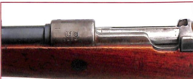
Linke Partie des Schutztruppengewehres 98 mit der S. Nr. 7530 c. Auf dem Hülsenkopf ist der Ansatz eines Tr. Stempels sowie der Eigentumsstempel der Z. A. R. über der S. Nr. zu sehen.
