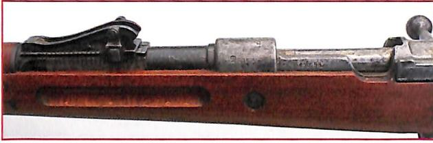
*Gewehr 98 Spandau 1914 mit der S. Nr. 3586g mit Visiersockel der eine Skalierung von 200 und 2.000 m aufweist.*
