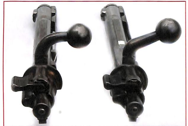
Rückseitige Ansicht der Verschlüsse aus den Schutztruppengewehren 98 mit der S. Nr. 7530c und 10, von links nach rechts. Deutlich ist die unterschiedliche Biegung des Kammerstängels und die am Kammerstängelansatz eingebrachten Buchstaben zu erkennen.
