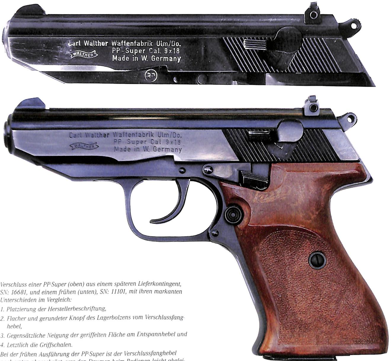
Verschluss einer PP-Super (oben) aus einem späteren Lieferkontingent, SN: 16681, und einem frühen (unten), SN: 11101, mit ihren markanten Unterschieden im Vergleich:
