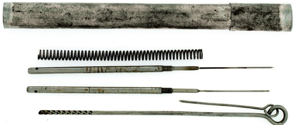
se sechs Zähne. Da der Karabiner aber keine Luftkammer, sondern nur eine flache Reaktionskammer hat, ist der Reiniger hierfür am Ende rund. Er dient zum Auswischen der Kammer und hat einen Einschnitt, in welchen der Schraubenzieher gesteckt wird, um ihn als Handhabe beim Aus- und Einschrauben des Nadelrohres zu gebrauchen.
