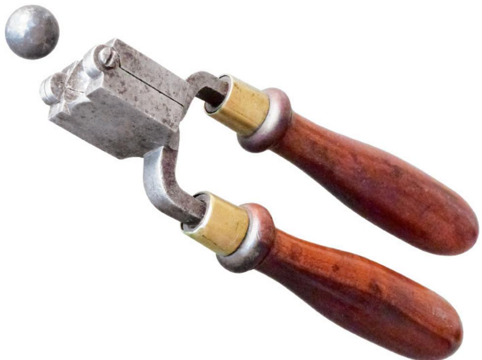
Mit Sicherheit ließe sich mit diesem Werkzeug auch der Gushals eines Geschosses entfernen, das einen etwas geringeren Durchmesser als der Innenraum der beiden halbkugeligen Hohlräume hat. Dann aber bliebe bestimmt ein jeweils mehr oder minder großer Rest des Gushalses am Geschoss zurück mit allen seinen bereits erklärten nachteiligen Folgen. Es wäre wenig mehr als ein Notbehelf, und zumindest das Messer müsste wieder in Aktion treten.
