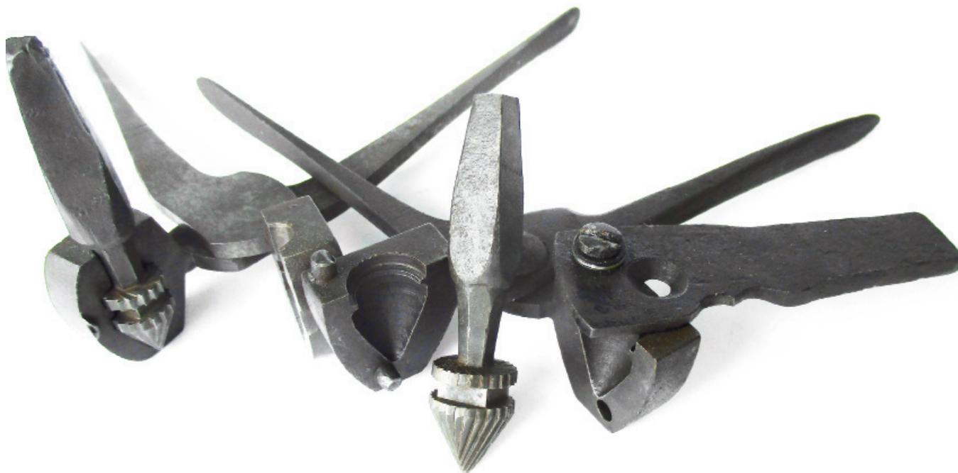
▲ Kugelzangen mit Profilfräser (siehe auch Abb. Seite 19 unten, hier mit Bleigeschoss)
