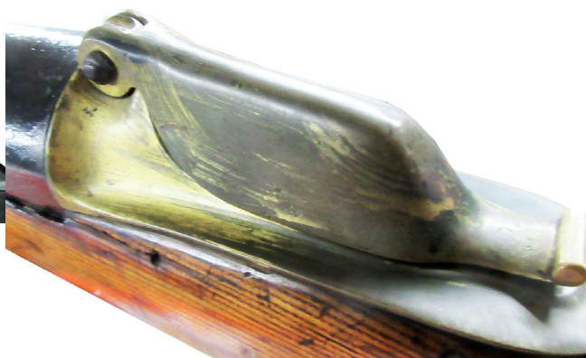
▲ Einläufige Harpunenkanone; auch hier wird das Perkussionschloss durch eine Wasserschutzhaube vor Wassereinwirkung geschützt (Abb. oben und rechts).
