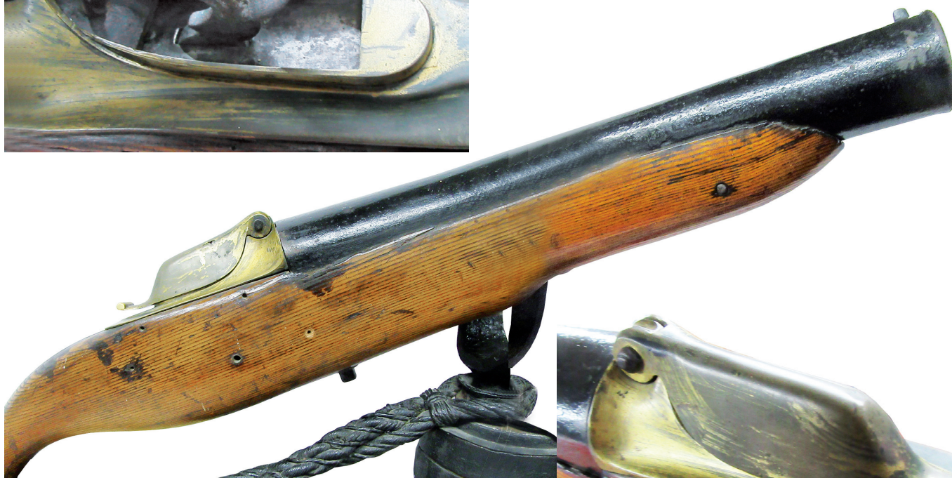
▲ Einläufige Harpunenkanone; auch hier wird das Perkussionschloss durch eine Wasserschutzhaube vor Wassereinwirkung geschützt (Abb. oben und rechts).
