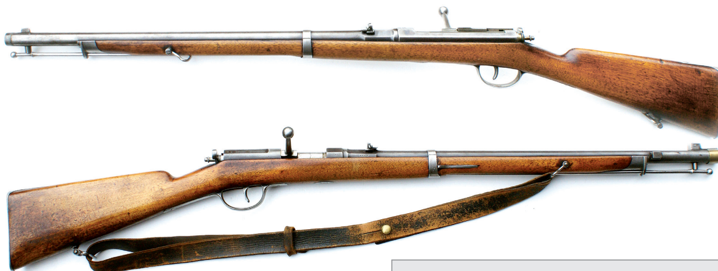
▲ Selbstspannendes Zündnadelgewehr System Dreyse für den badischen Zoll mit originalem Gewehrriemen und Mündungsdeckel
