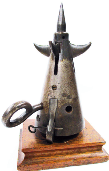
Aufschaubarer Harpunenkopf; der Vorstecker sicherte die Widerhaken.
