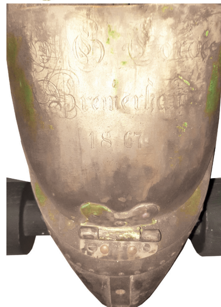
▲ Doppelläufige Harpunenkanone aus dem Jahr 1867 in Perkussionszündung mit Abdeckhaube zum Schutz gegen Wasser mit aufwändiger Herstellersignatur
