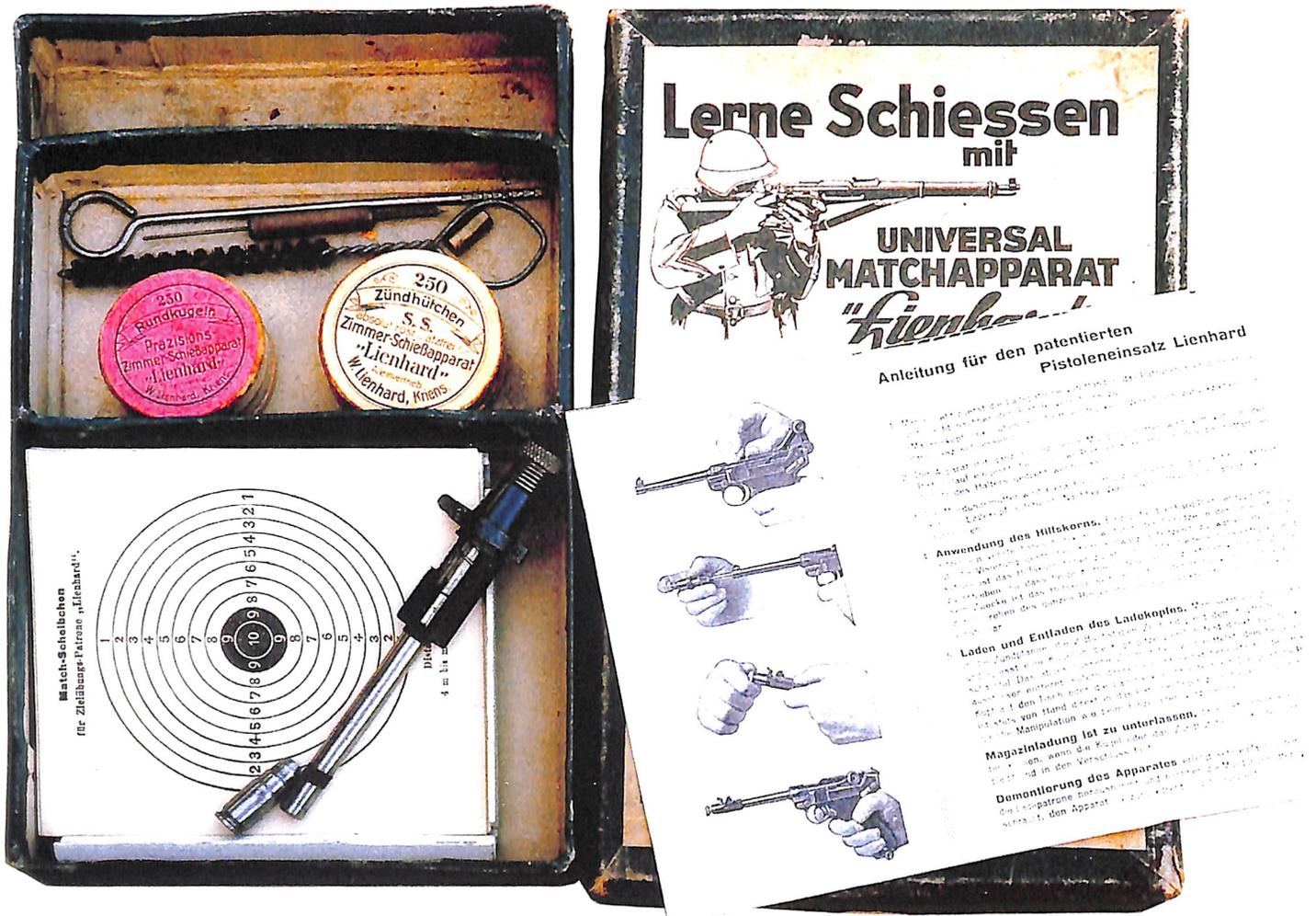
„Matchapparat Lienhard“, Kaliber 4 mm für Kaliber 7,65 mm Parabellum, Lauflänge 120 mm
