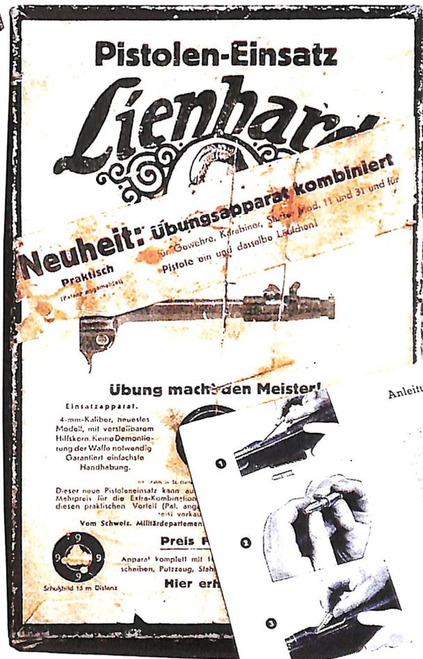
Lienhard „Übungsapparat kombiniert“ Kaliber 4 mm für Parabellum-Pistolen Kaliber 7,65 mm, Lauflänge 120 mm und Langwaffen im Kaliber 7,5 mm x 55 Schweiz Ordonanz
