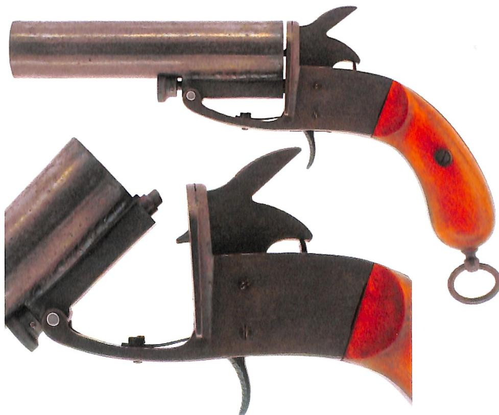
Die links abgebildete einläufige Signalpistole ist gänzlich aus Eisen gefertigt. Der Spalt zwischen Laufmund und Basküle dient der Aufnahme des Patronenrandes; die Laufverriegelung entspricht einem Prototyp der Pionier-(Signal-)pistole (Vorgänger der Signalpistole Hebel) und spricht für eine Fertigung während des Ersten Weltkrieges.
