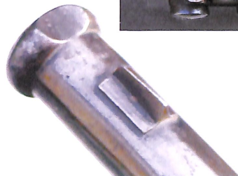
▲ Standkimme, kleine und große Klappe (100, 200 und 300 Schritt); rechts die segmentförmige Ausnehmung im Bereich der Visierlinie
