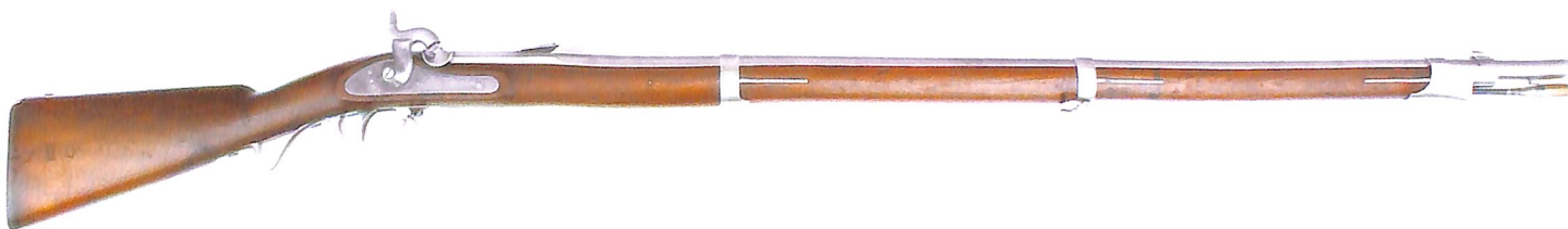
▲ Badisches Infanteriegewehr M 57 (Vereinsgewehr) Kal. 13,9 mm, welches als Basis für das Versuchsgewehr verwendet wurde
