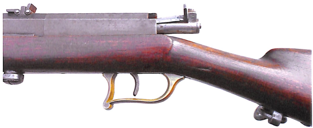
▲ Karabiner verriegelt und Verschluss entspannt; Messingabzugsbügel
