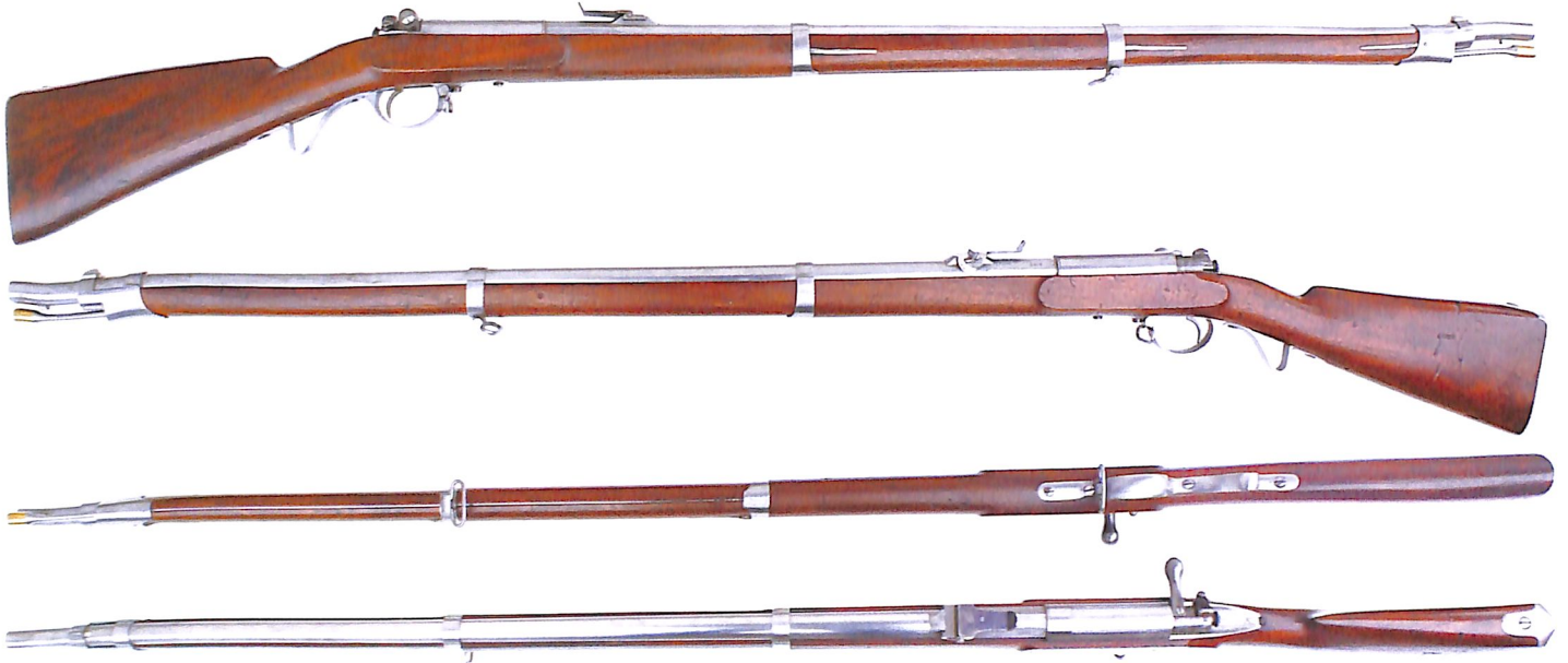
▲ Versuchsgewehr mit dem System Spangenberg und Sauer im Kaliber 13,9 mm
