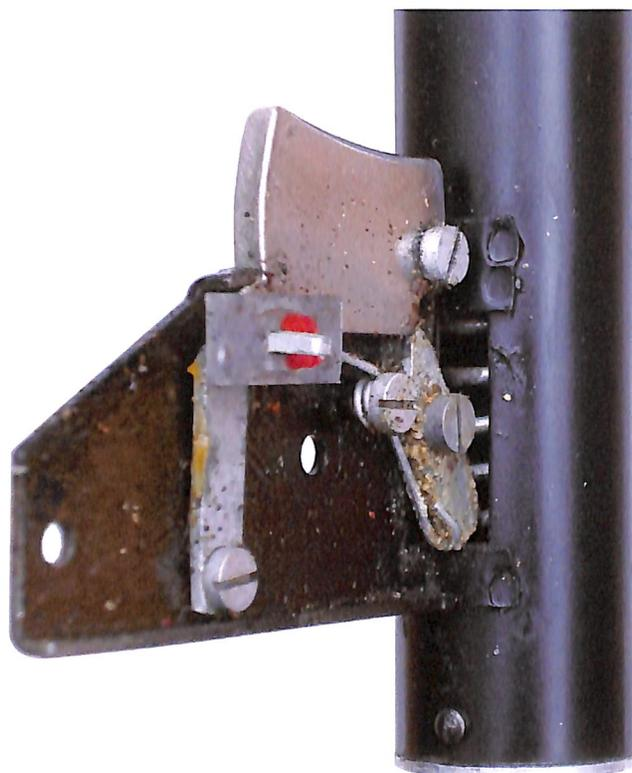
▲ Blick in die Technik der Notwehrpistole mit Abzugs- und Sicherungseinrichtung: Der Block legt sich in gesichertem Zustand hinter den Abzug und blockiert diesen; im Verschluss- bzw. dem verlängerten Laufbereich ist die starke Spannfeder erkennbar.
