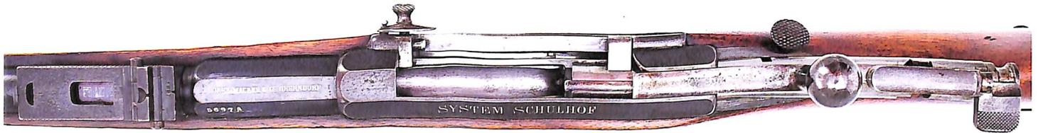
▲ System mit offenem Verschluss, der Sicherungsflügel und der runde Abzugsdrücker sind gut erkennbar.
