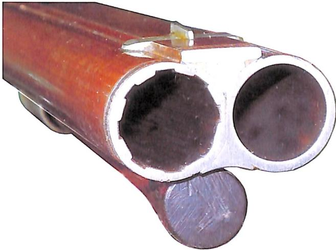
▲ Beim Standard-Laufpaar der nebeneinanderliegenden Damastläufe ist der rechte Lauf als gezogener Büchsenlauf mit acht rechteckigen Zügen für ein Bleigeschoss aus der beiliegenden Kokille im Kaliber .58 (14,75 mm) ausgeführt; der linke Lauf ist als Flintenlauf konzipiert und hat ein Kaliber von 15 mm.
