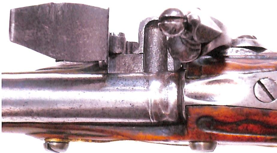
◀ Ansicht auf den Schloss- und Pulverkammerbereich mit der Visiermulde in der sog. Schwanzschraube
