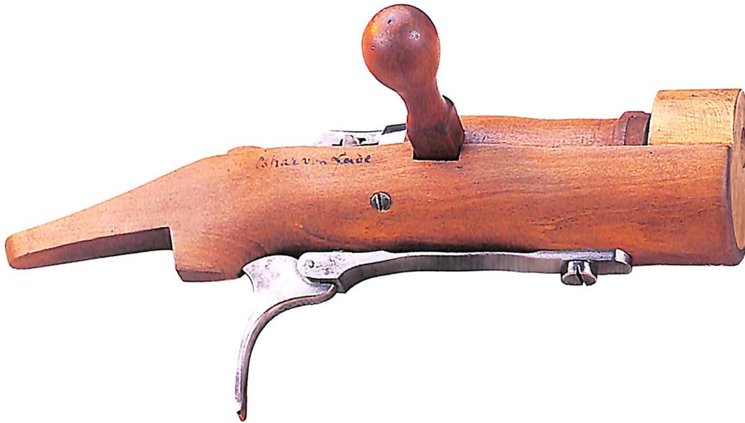
◀ Komplettes Verschluss-system (verriegelt) mit Abzugseinrichtung des Modells I; Abzugseinheit und Spannvorrichtung sind aus Metall; die durch die Hülse geführte Schraube fixiert den vorderen Spannstellen.
